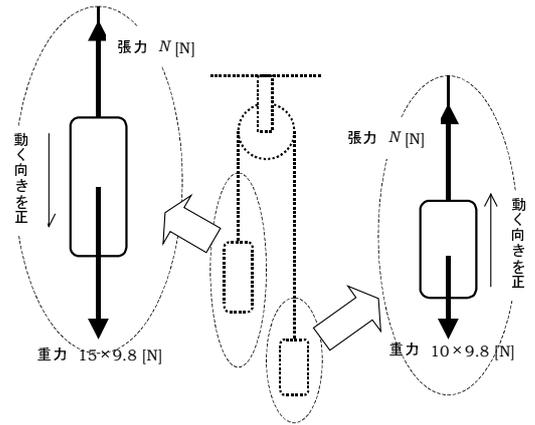
※ よくある間違い例 → 注目する物体以外に目移って運動方程式を誤る! 反対側の物体の力は無視して、その物体にかかるロープの張力に集中する。ロープの張力を通して反対側の影響が含まれてくるのだ!
