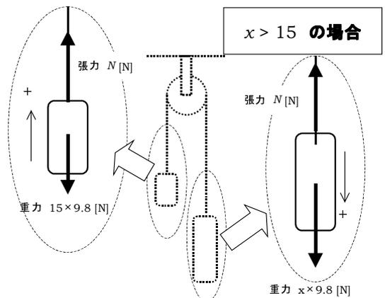
※「運動方程式 初歩③」の答え※ (2)  $a=0.2[m/s^2]$ 、 $S=20[N]$ 、 $T=10[N]$  (3)  $a=2.5[m/s^2]$ 、 $T=15[N]$
