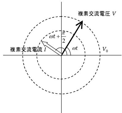
コンデンサーのリアクタンスは  $Z = \frac{1}{i\omega C} = 0 - \frac{1}{\omega C}i = \frac{1}{\omega C}e^{-i\frac{\pi}{2}}$  である。
