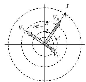
ルの和を求めるとき、 $\sqrt{V_R^2 + (V_L - V_C)^2} = I_0 \sqrt{R^2 + \left(\omega L - \frac{1}{\omega C}\right)^2}$  が電圧の最大値である。また、電圧のベクト
