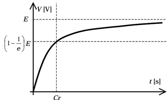
内部抵抗が  $1.0[\Omega]$ 、コンデンサーの容量が  $1.0[\mu\text{F}]$  として充電時間を求めてみると、
