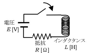
ヒホッフの第一法則 (閉回路を 1 周するとき、起電力の和は抵抗の電圧降下に等しい) より、
