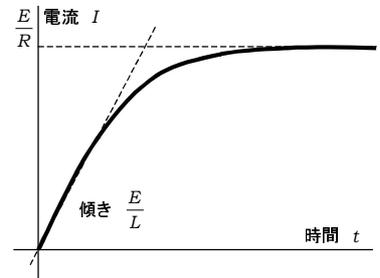
特別 電流を  $I = f(t) + \frac{E}{R}$  を、 $E - L \frac{dI}{dt} = IR$  に代入して、 $\frac{df(t)}{dt} = -\frac{R}{L} f(t)$
