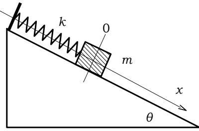
ばねが自然長から  $x_0$  だけ伸びた位置を原点として、鉛直下向きに  $x$  の位置における運動方程式を作ると  $ma = -k(x_0 + x) + mg \sin \theta$  である。 $x_0 = \frac{mg \sin \theta}{k}$  を代入して、小物体の加速度  $a$  を求めるとは  $a = -\frac{k}{m} \cdot x$  となる。この結果は、水平に置かれたばね、鉛直におかれたばねの場合と同一の結果だ。よって、「**加速度  $a$  と変位  $x$  の向きが反対向きであり、それらの大きさは比例している**」となっているので、この場合も単振動となることが分かる。
