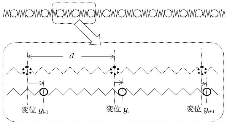
が成立する。整理すると、左からの圧力は  $P = P_0 \left(1 - \frac{y_{i-1} - y_i}{d}\right)^{-\gamma}$  である。変位  $x$  は間隔  $d$  に比べて十分
